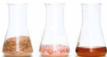
ca. 60% Reishülsen + ca. 22% Steinsalz + ca. 18% Mineralöl = Resysta
